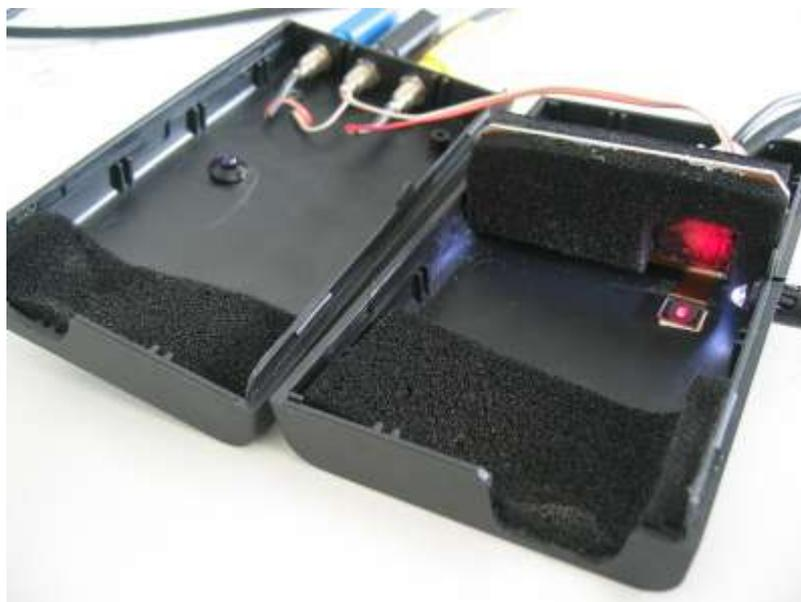
Abbildung 7.1: Black-Box (geöffnet) zur Simulation von Umgebungslichtinterferenzen
